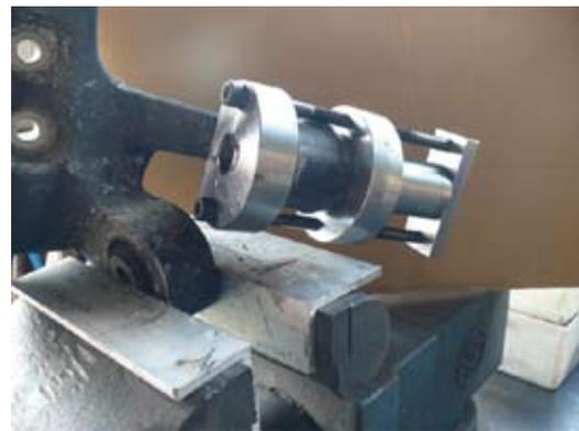
M8ボルトが底つくまで2本のボルトを交互に締め付けながらセットしロックナットを締め付けます。
