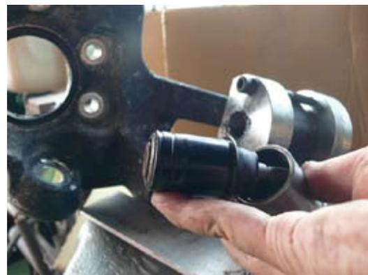
② 画像(図)のように押しゴマの上にフタを被せ長方形の治具をセットします。2本のボルトには予めロックナットを入れておきます。
